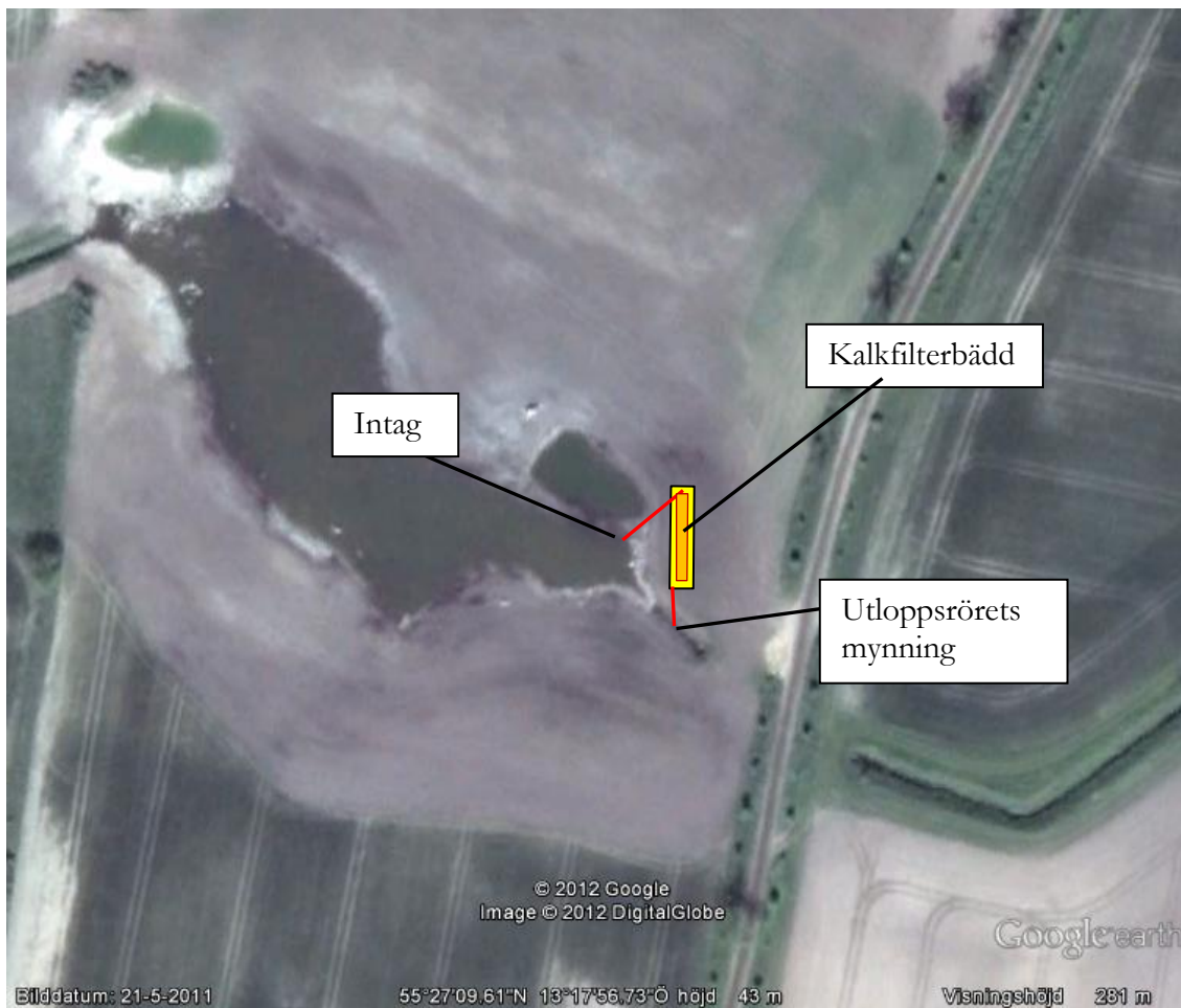
Figur 27: Den färdiga kalkfilterbäddens läge i förhållande till dammen och Tullstorpsån. Filterbäddens yta på marknivå är 21,5 \text{ m} \times 5,5 \text{ m} . I botten är bädden 18,3 \text{ m} lång och 1,8 \text{ m} bred. Kalkfiltervolymen är 54 \text{ m}^3 .
